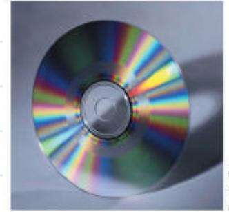
I solchi assai vicini di un compact disc diffrangono la luce bianca scomponendola nei suoi colori fondamentali. La diffrazione è definita come l'interferenza costruttiva e distruttiva di onde luminose.
